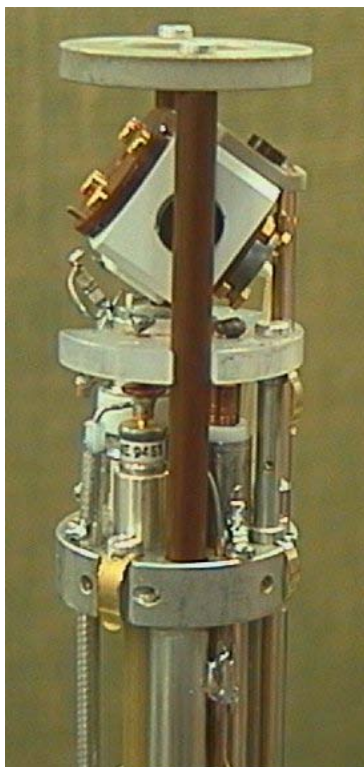
Figura 31. Interno di un probe con angolo magico e visione dell'insieme di uno spettrometro
