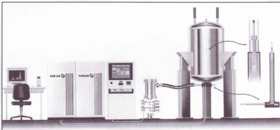
Schematizzazione sintetica di uno spettrometro con cryoprobe
